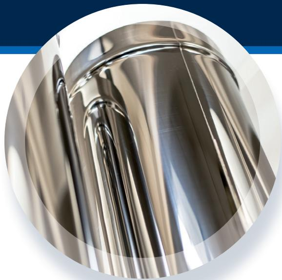
La serie CMPI6 (monoparete 304 spessore 0,6 mm) è consigliata esclusivamente per combustibili solidi con funzionamento a secco (ad esclusione delle stufe a pellet) ed impianti di aspirazione o ventilazione. La gamma viene realizzata in acciaio inox 304 spessore 0.6 mm con finitura BA (lucida); altri spessori possono essere realizzati su ordinazione. La saldatura è realizzata in maniera automatica a tig.
